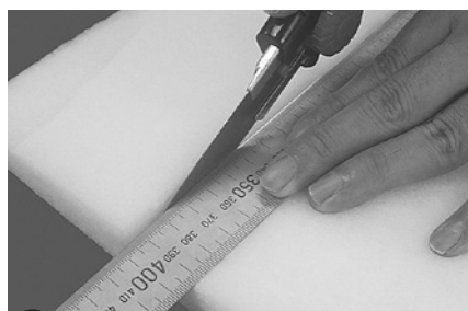
図1 薄いボードタイプは、オルファ社の超鋭角刃特選黒刃をご使用下さい。
